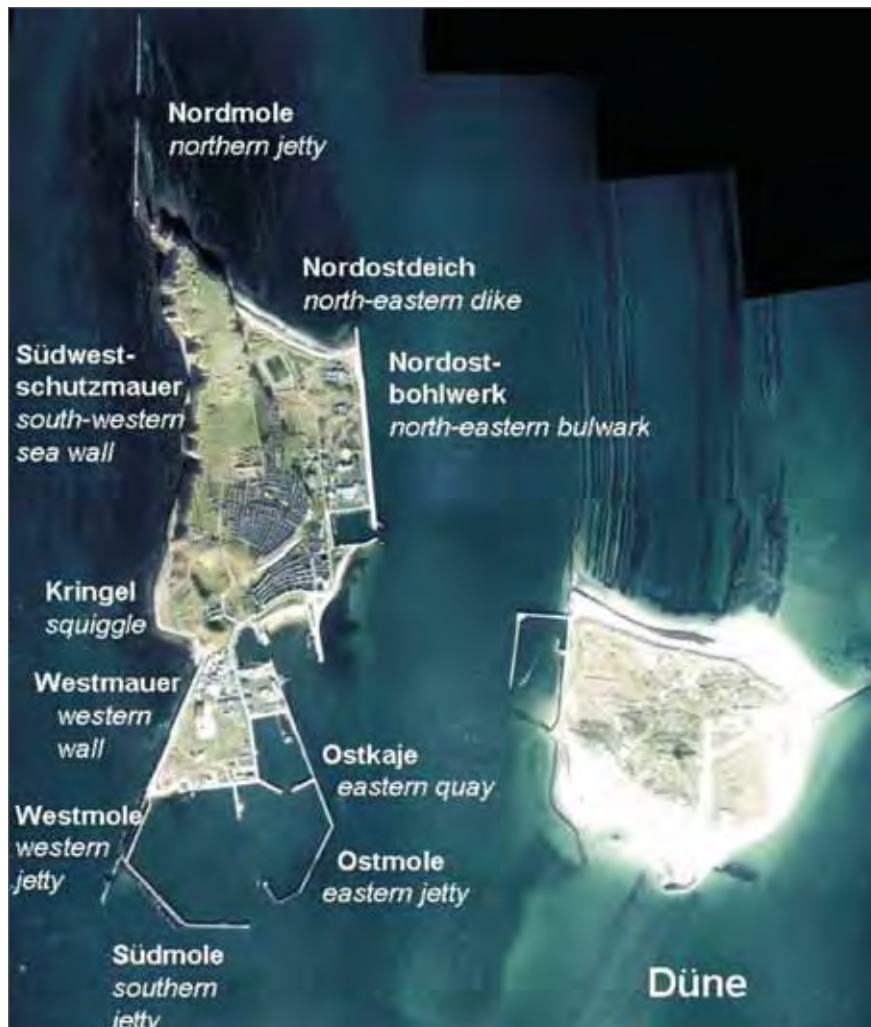
Abb. 15: Übersicht Helgoland: Felseninsel und Düne mit Küstenschutz- und Hafenanlagen (Bednarczyk: et al: 2008)
