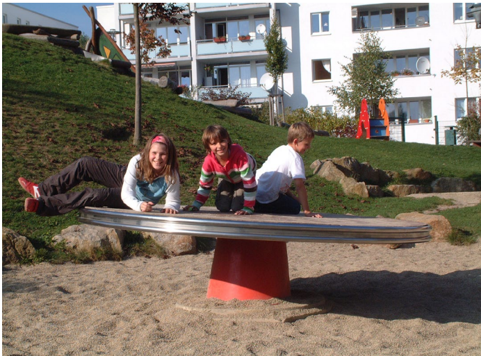
Abb. 9 Beispiel eines Karussells bzw. einer Drehscheibe mit umlaufendem Freiraum und Fallschutzmaterial
