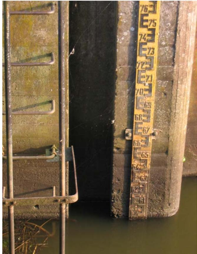
*Abbildung: Pegellatte am Deichsiel zwischen Schleusenritt und 2. Kleiritt im SV Hetlingen*
